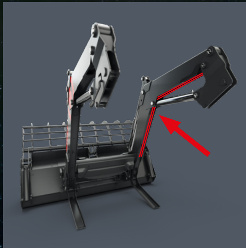
Rohrverlegung für REAL3 rd
