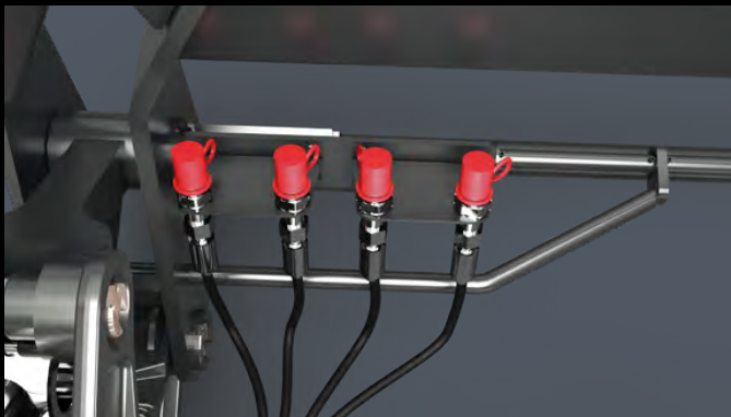
3. UND 4. STEUERKREIS. (hier als Steckkupplung) Für das einfache Bedienen hydraulischer Werkzeuge wie Silagezangen, Ballengreifer oder Ballenhubstapler.
